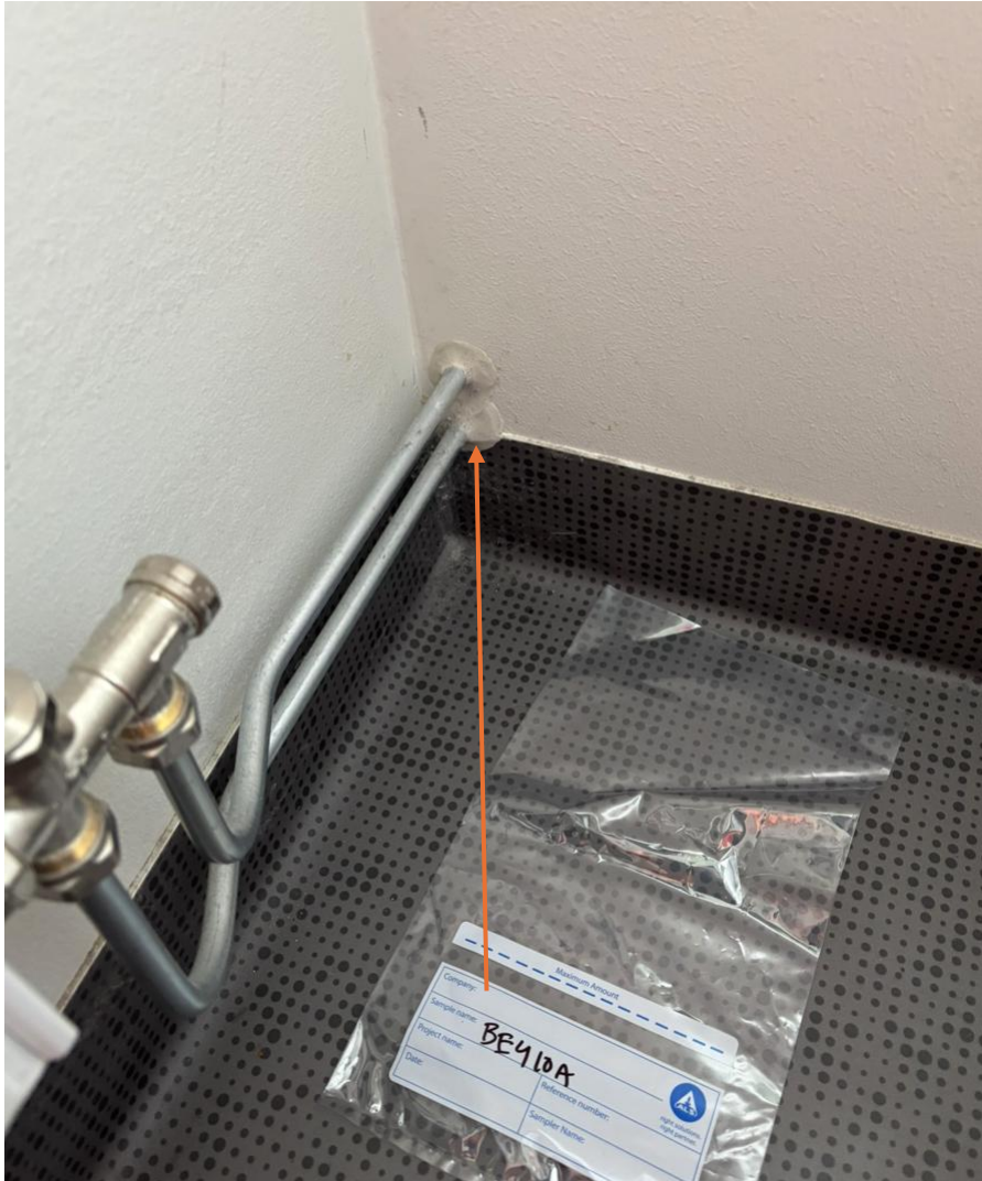
Figur 4. BE410A, rörfog från Plan 4 Begonia. Inga halter över laboratoriets rapporteringsgräns.
