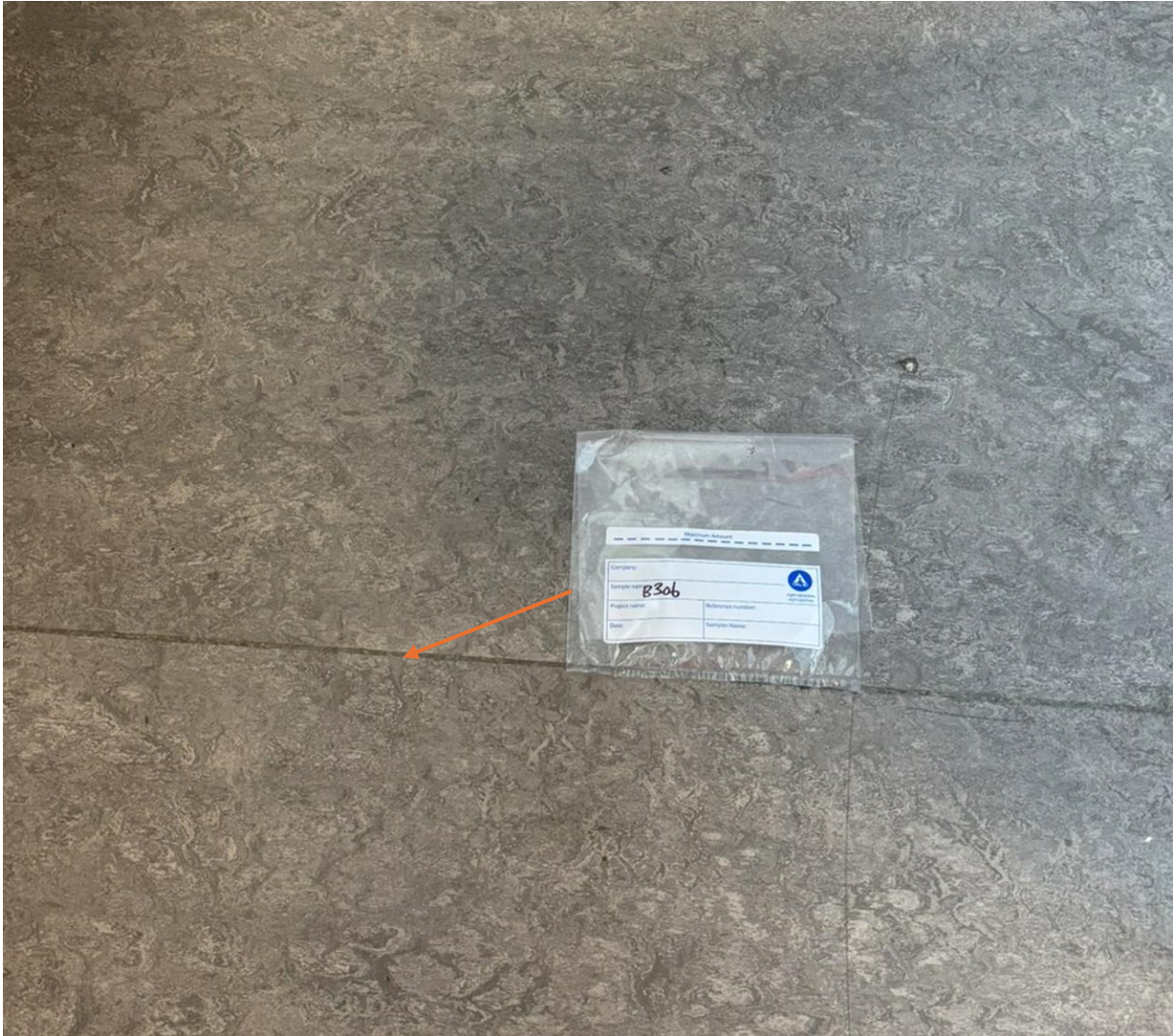
Figur 3. BE306, mattfog från Plan 3 Begonia. Inga halter över laboratoriets rapporteringsgräns.
