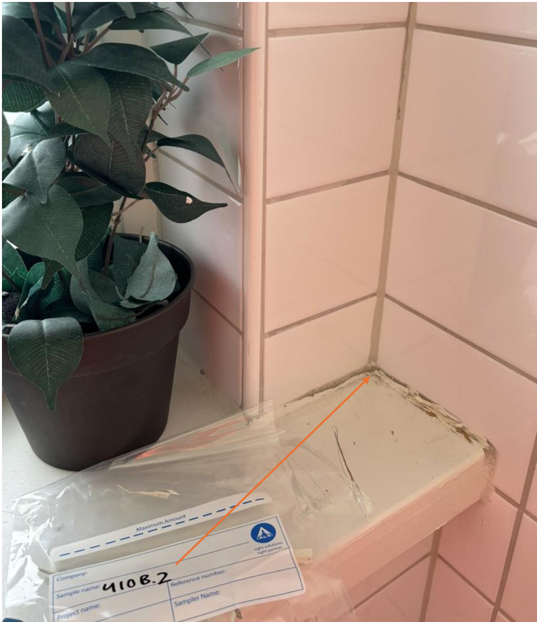
Figur 6. BE410B.2, mjukfog badrum från Plan 4 Begonia. Inga halter över laboratorets rapporteringsgräns.
