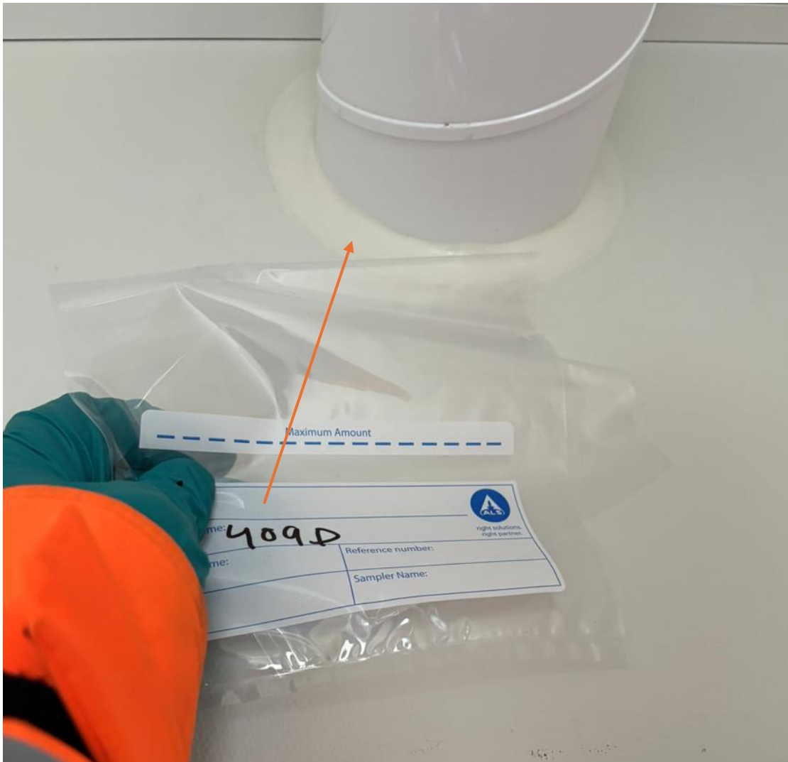
Figur 5. BE409D, rörfog från Plan 4 Begonia. Inga halter över laboratorets rapporteringsgräns.
